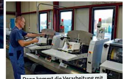
Dann kommt die Verarbeitung mit Schneiden, Einhängen und Heften.
